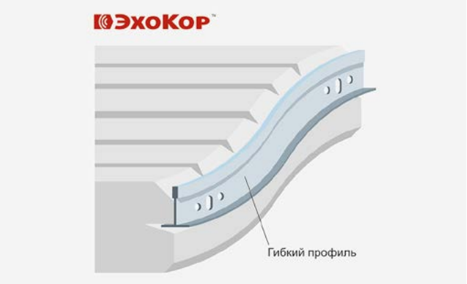
Изгибаемые вдоль короткой стороны акустические панели
