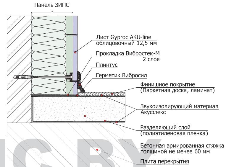
**5.2.3 Схема примыкания конструкции плавающего пола с применением звукоизолирующего материала Акуфлекс к стене и трубе отопления/водопровода**
